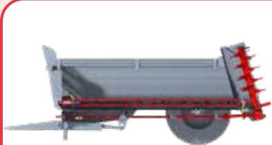
Cadena cinemática con transmisión bajo el eje rebajado (ideal para terrenos inclinados). Anillos de desgaste en rodamientos traseros. Rueda libre en el cardán trasero. Baberos de hermeticidad delanteros y sobre la tabla de esparcimiento.
