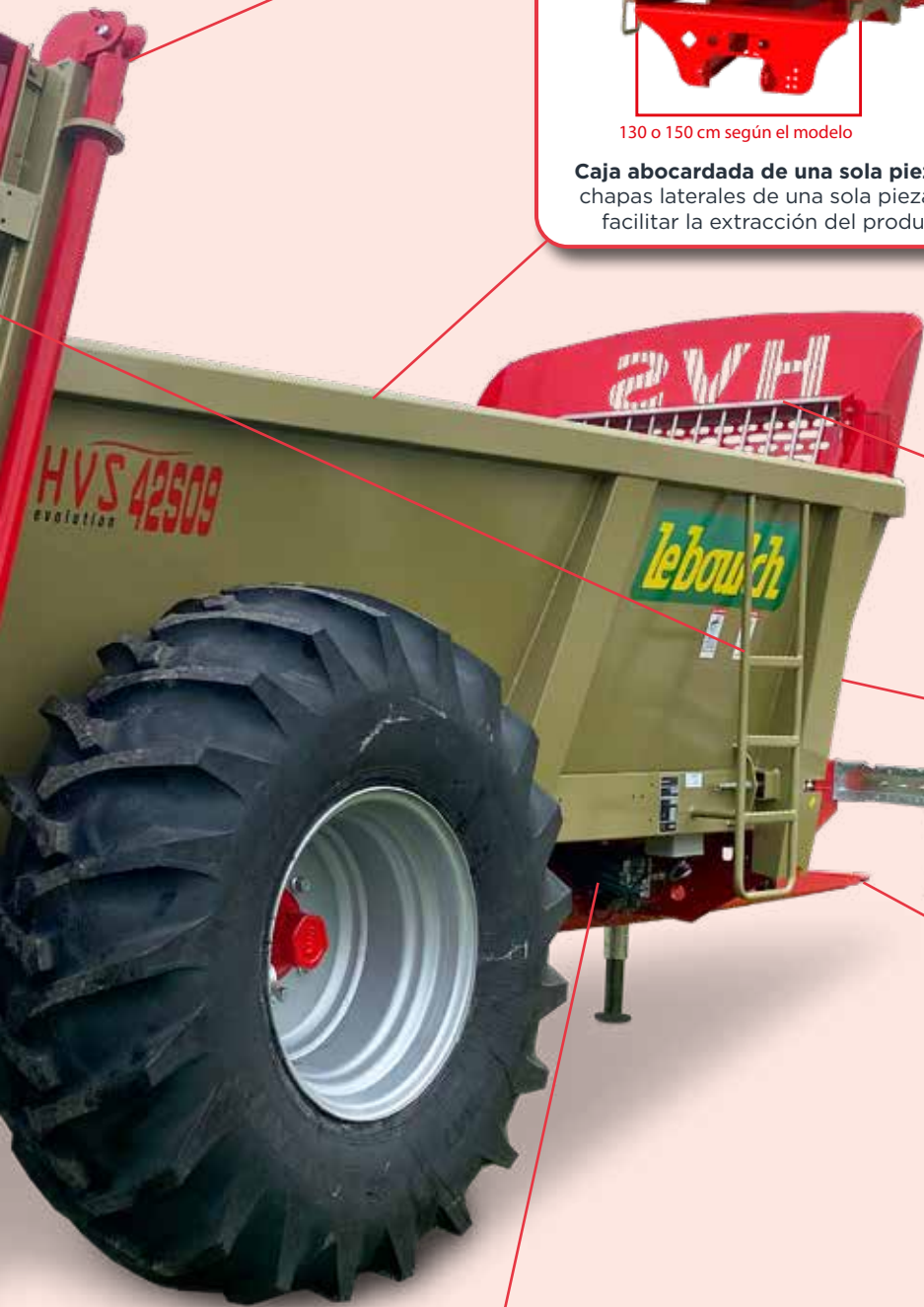
Cadena cinemática con transmisión bajo el eje rebajado (ideal para terrenos inclinados). Anillos de desgaste en rodamientos traseros. Rueda libre en el cardán trasero. Baberos de hermeticidad delanteros y sobre la tabla de esparcimiento.
